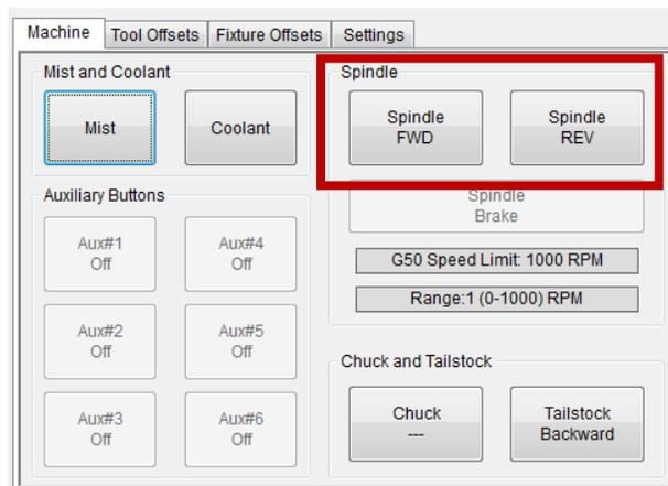
FIGURE 14 – SPINDLE CONTROL
